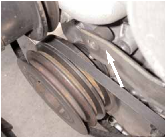
Photo #1 - Missing bolt.
